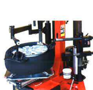
マウントプレス装置、 ビードプレス装置の併用 によるタイヤの組込み
