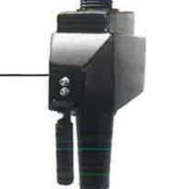
垂直アーム、水平アームはダブルロック方式により、ボタン操作で簡単にロックできます。ホイールとMLIツールとの隙間は、自動的にセットされます。(自動クリアランス調整機能)
